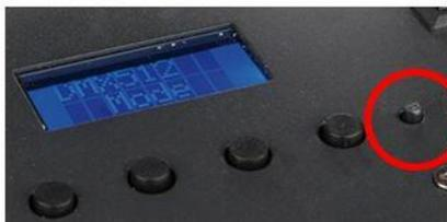
Abb. 06 Trenntaste für die kabellose DMX-Übertragung
